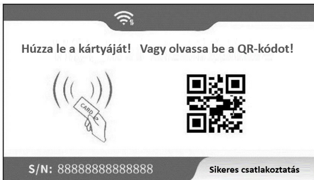
6-10. ábra Az LCD képernyő kijelzése a csatlakoztatás után
