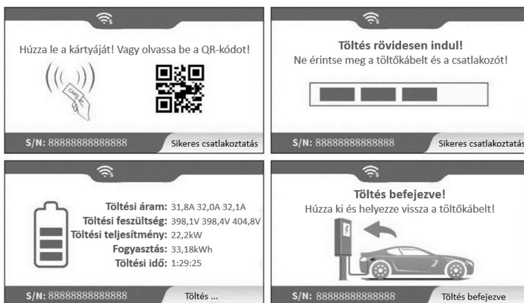
6-3. ábra A normál töltés kijelzése
